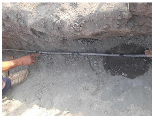
شکل ۷- انسداد برخی قطره‌چکان‌ها (تصویر راست) و هجوم ریشه به سمت خروجی قطره‌چکان (تصویر چپ) (نورجو، ۱۴۰۲)
