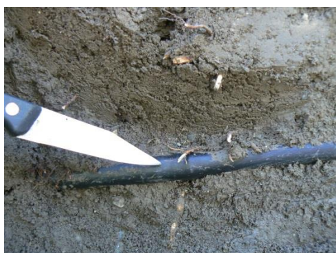
شکل ۷- انسداد برخی قطره‌چکان‌ها (تصویر راست) و هجوم ریشه به سمت خروجی قطره‌چکان (تصویر چپ) (نورجو، ۱۴۰۲)
