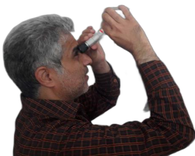
شکل ۲- اندازه‌گیری مواد جامد قابل حل انگور رقم یاقوتی با استفاده از دستگاه رفاکتومتر دستی
